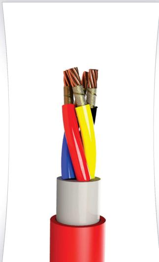
کابل های قدرت مقاوم در برابر آتش ( بدون هالوژن و کم دود با نوار میکا و عایق XLPE )
